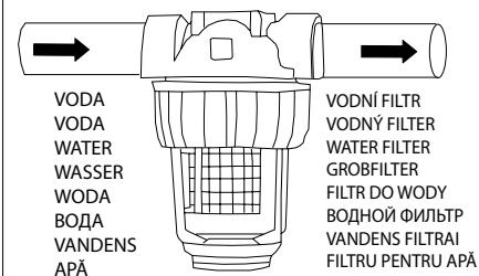
Na prívode vody musí byť nainstalovaný vodný filter!
